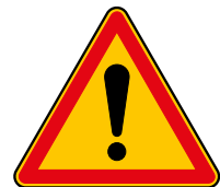
AK14 Autres dangers. La nature du danger peut être précisée par une inscription (KM)
