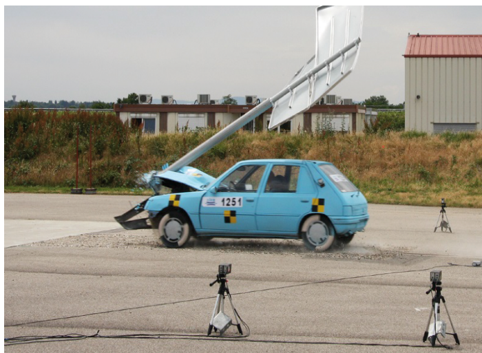
Test d'un dispositif à sécurité passive (Source : DIRA)
