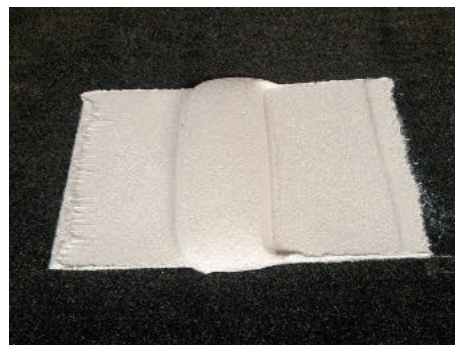
Figure 28 : Exemple de marquage VNTP en enduit à froid, DAS : barrettes
