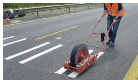
Figure 2 : Exemple de mesure du séchage du produit
