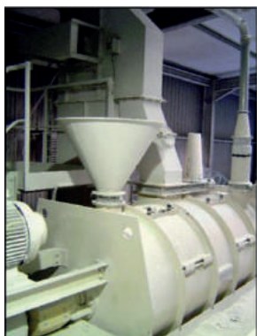
Figure 9 : Vue extérieure du mélangeur
