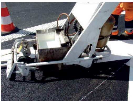
Figure 48 : Application d'enduit à chaud au sabot
